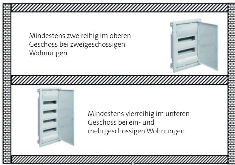
Bild 3: Größe der Stromkreisverteiler in einer Wohnung
