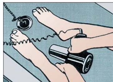
Bild 6: Selbstversuch in der Badewanne, Gerät mit rechter Hand umfasst, Füße berühren den Abfluss nicht
